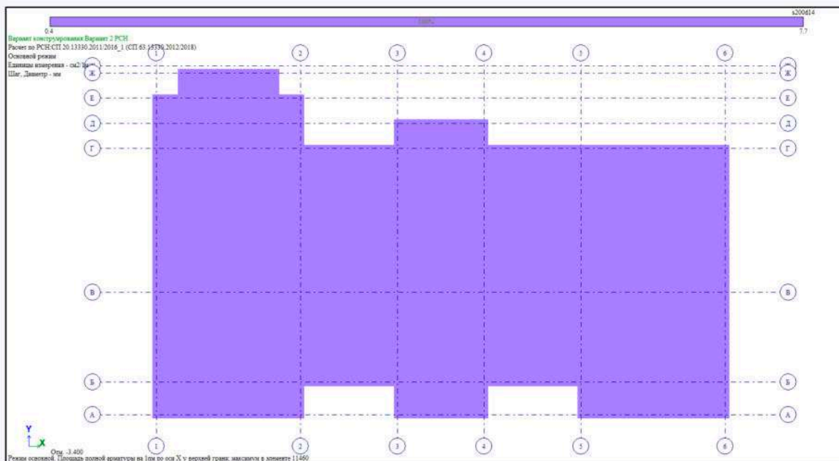
Рис.103. Площадь полной арматуры на 1 пм по оси X у верхней грани фундаментной плиты
