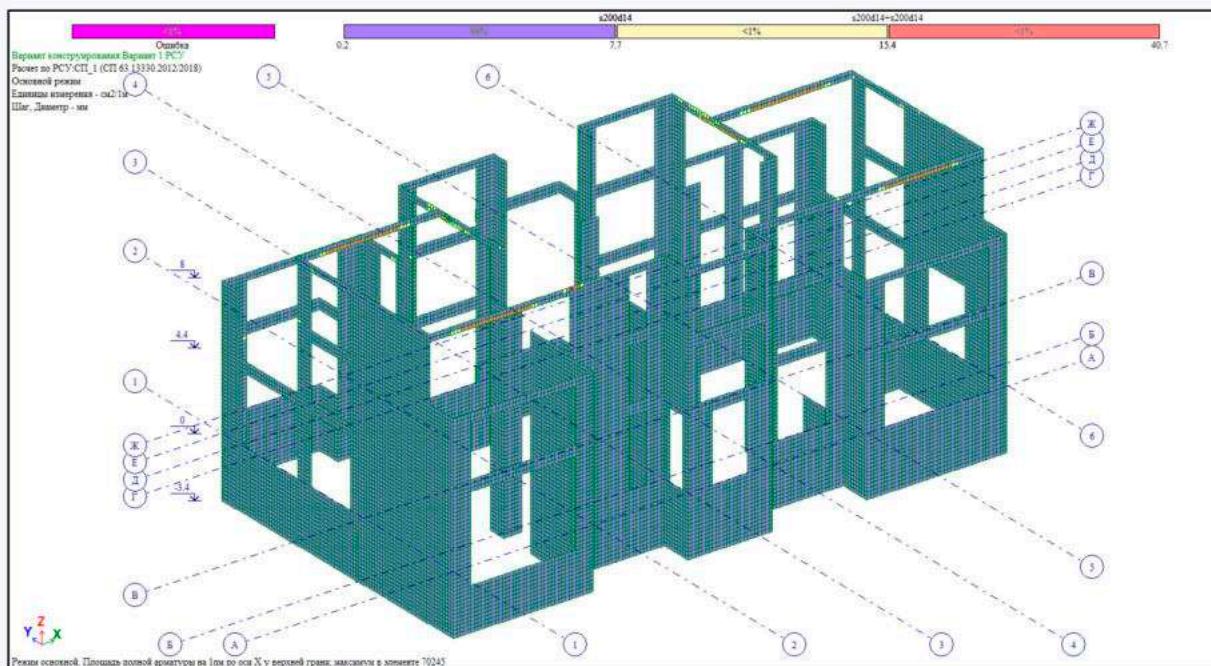
Рис.65. Площадь полной арматуры на 1 м по оси X у внутренней грани стены
