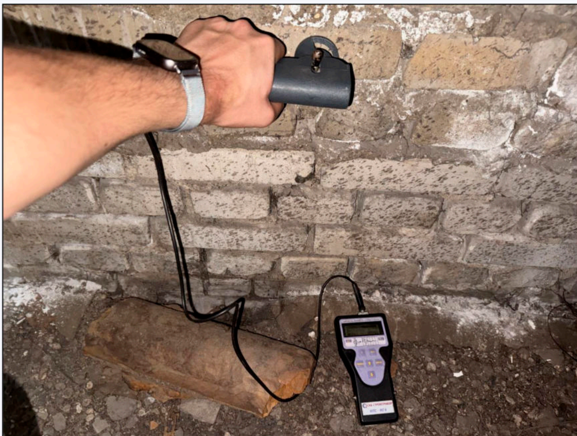
Фото 29. Определение прочностных характеристик кирпичной кладки в уровне чердачного помещения прибором ИПС-МГ4.03
