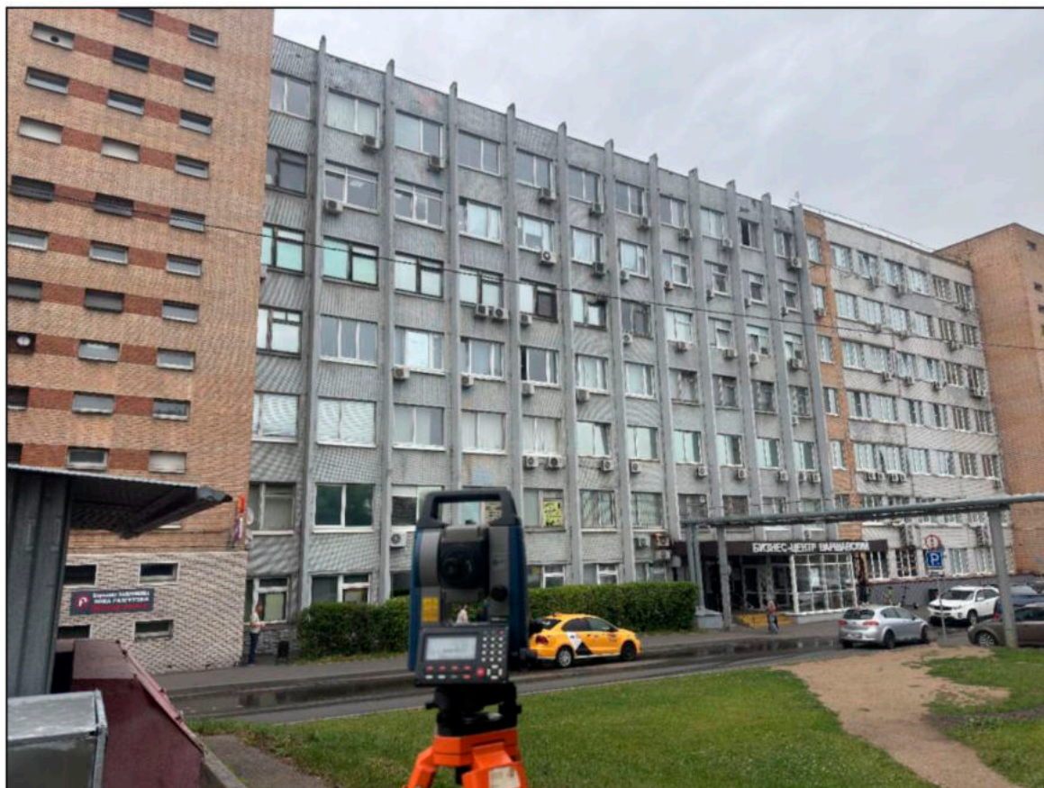
Фото 16. Проведение тахеометрической съемки прибором Тахеометр электронный «SOKKIA»
