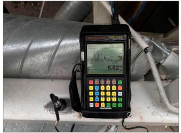
Фото 66. Полученные значения при измерении толщины конструкций рамы
