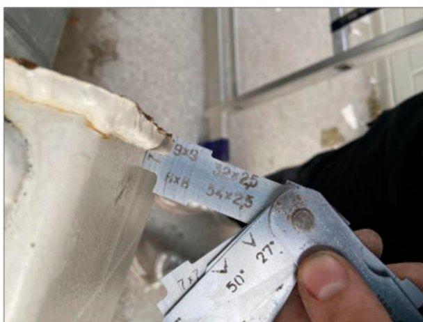
Фото 54. Измерение катета швов в узлах соединения элементов рамы каркаса
