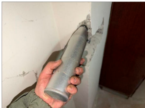
Фото 46. Общий вид измерения прочностных характеристик вертикальных конструкций методом упругого отскока.
