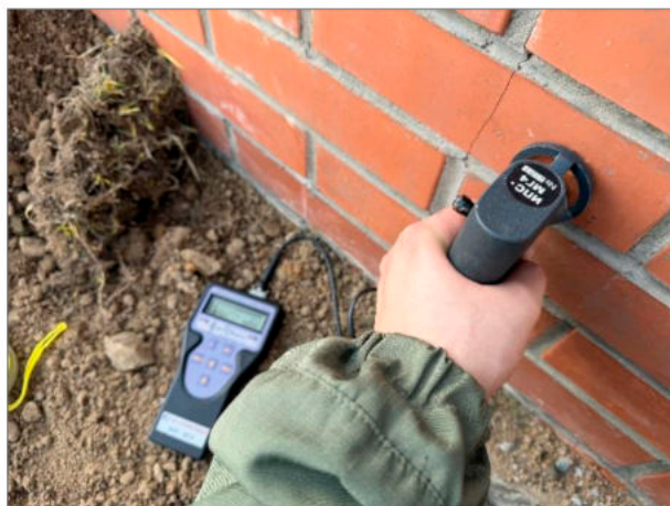
Фото 51. Измерение прочностных характеристик материалов наружных стен методом ударного импульса
