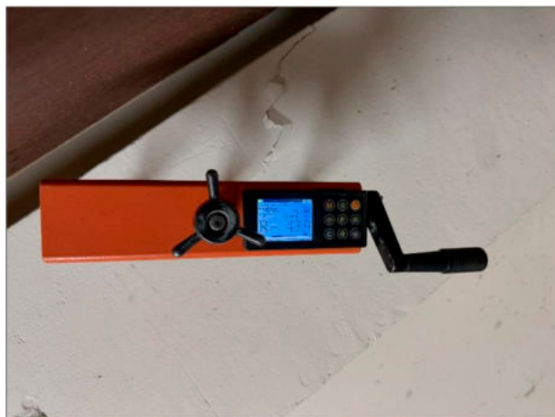
Фото 45. Общий вид измерения прочностных характеристик вертикальных конструкций методом отрыва со скалыванием.
