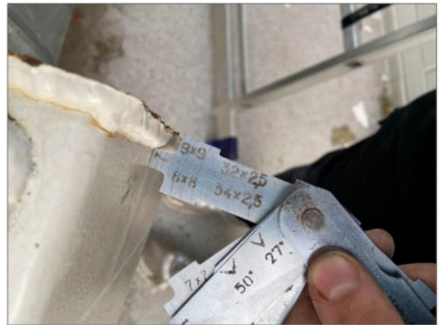
Фото 68. Измерение катета швов в узлах соединения элементов рамы каркаса
