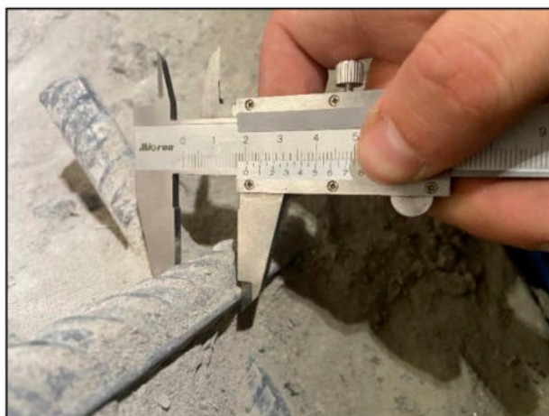
Фото 15. Общий вид измерения геометрических характеристик выполненного вскрытия.
